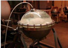
Figure: Réservoir test de ballotement de ATK ( Ballinger, AIAA, 2003 )
